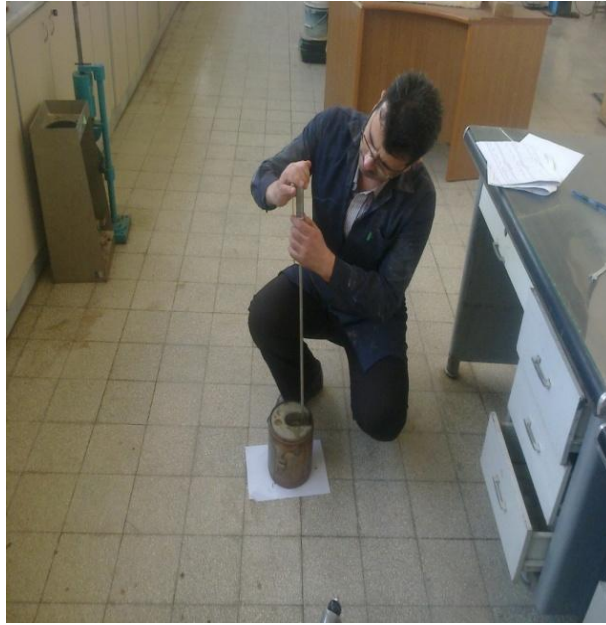
شكل ( 3 - 38 ) : صورة تبين تجربة البروانة ضمن قالب الـ CBR .
